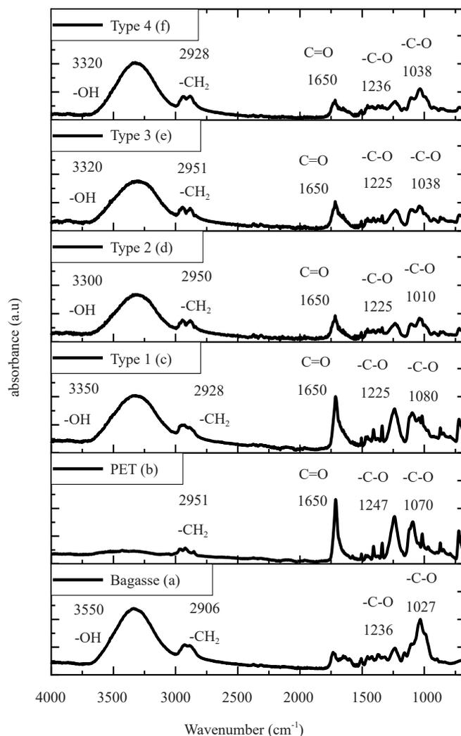
Figure 4. FTIR spectra of (a) Bagasse; (b) PET; (c) Type 1; (d) Type 2; (e) Type 3; (f) Type 4
